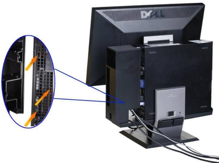
**10. Premere l'interruttore di blocco della copertura cavi per fissare la copertura alla base.**
