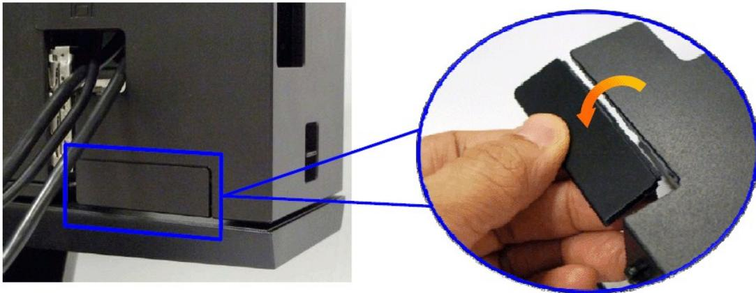
Togliere "l'elemento di protezione" strappando lungo la linea di contorno.
